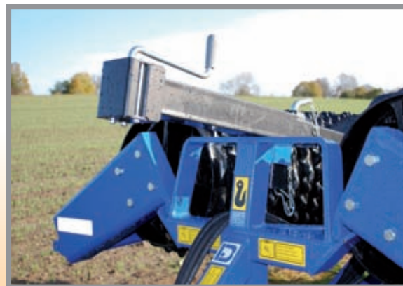
Under transport placeres støtteben i spec. holder.
